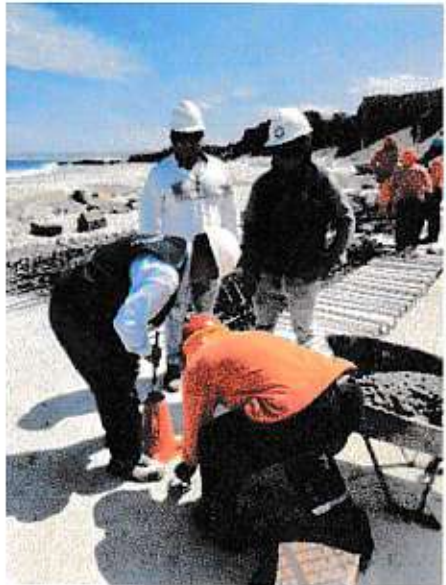
ENSAYO DE CONO DE ABRAHAMS, VERIFICACION DEL SLUMP
